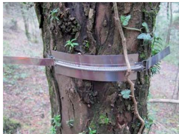
Figura 2. Dendròmetre de banda en un teix podat
